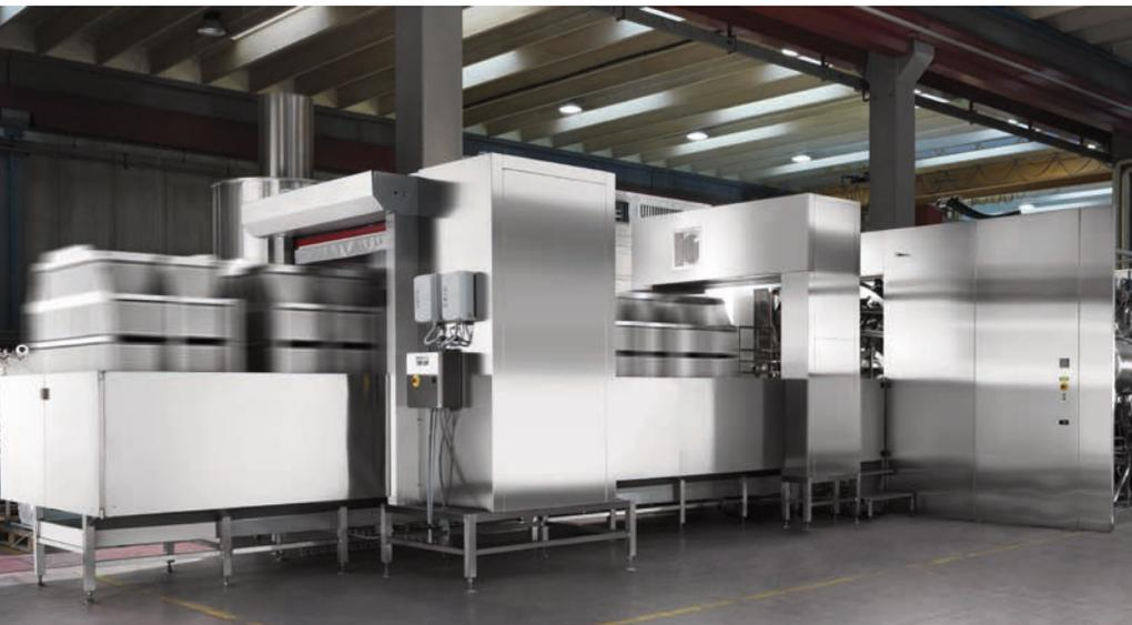
Sopra, Fedegari è in grado di sviluppare soluzioni integrate come sterilizzatori ad acqua surriscaldata con sistema di asciugatura
