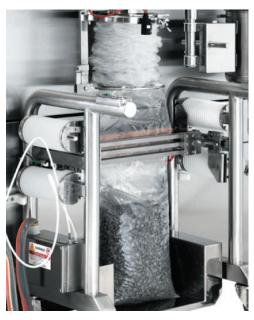
7. Befüllen des Beutels mit den Verschlüssen. Wenn das gewünschte Volumen/Gewicht erreicht wird, stoppt die Steuerung des Sterilisator die Drehbewegung der Trommel innerhalb des Autoklaven. Nach Verschweißen des Beutels wird die zuvor beschriebene Aktion solange wiederholt, bis die gesamte Beladung des Sterilisators verpackt ist.
