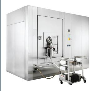
3. Die Verschlüsse werden in einem einzigen Prozess gewaschen, silikonisiert, sterilisiert und anschließend getrocknet. Am Ende des Laufs können sie ohne physischen Kontakt mit einem Bediener aus der Trommel entladen werden.
