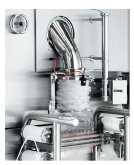
5. Montieren der PE-Beutelrolle an den Adapter und Durchziehen des Beutelmaterials durch die Schweißvorrichtung.
