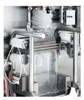
6. Nach dem Verschweißen der erste Naht, Herunterziehen des halbfertigen Beutels, bis dieser die darunter liegende Waage erreicht.
